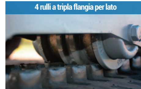
Il sottocarro più lungo della categoria è spinto da motori di trazione da 40,5 kN di forza
