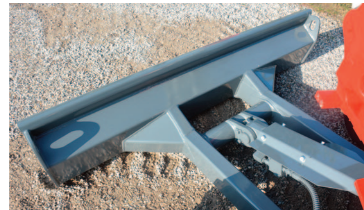
Lama HD scatolata e di struttura robusta
