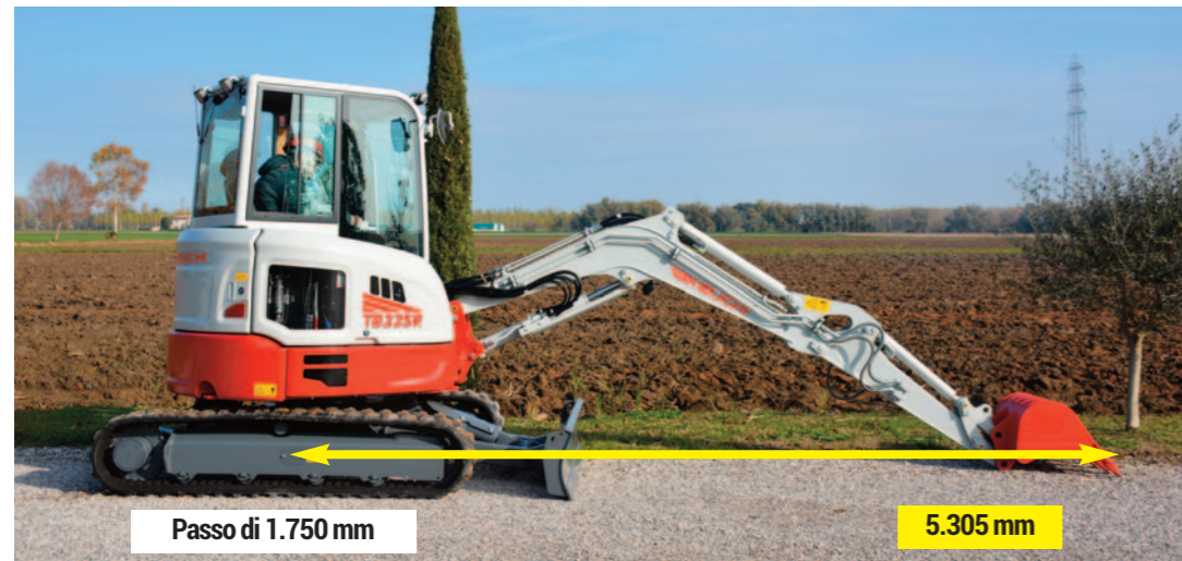
SOLO 80 MM OLTRE IL BORDO CINGOLO
