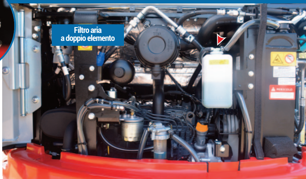
Vaso d'espansione refrigerante più alto della testata. Si prevengono surriscaldamenti
